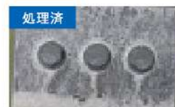
処理済 鋼板:ZAM(K35ZG) ボルト:SUS304 ジオメット処理
